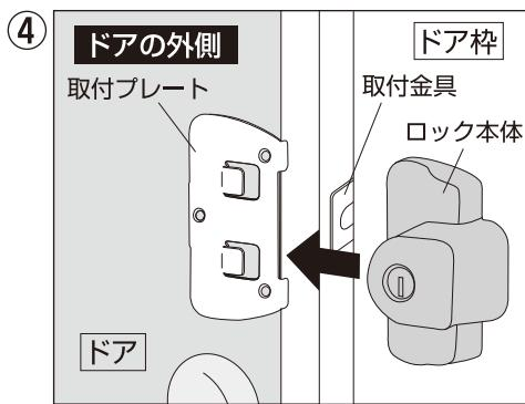
④取付プレートのツメに掛かるようにロック本体を装着して完了。
