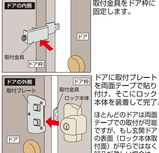
取付金具をドア枠に固定します。
