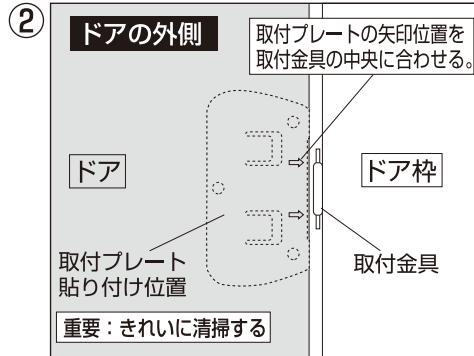
②取付金具を付けたままドアを閉め、取付プレートの矢印を参考に取付プレートの貼り付け位置を確認し、必ず取付位置のドア表面の汚れをきれいに除きます。
