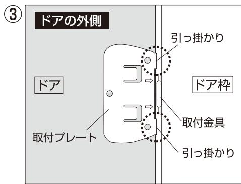
③取付プレート裏の両面テープをはがし、取付プレートの矢印と取付金具が合うように貼り付けます。この時、取付プレートにある2ヶ所の引っ掛けりが扉の角にピッタリ合うように押しつけてください。
