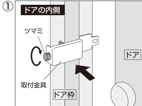
①取付金具をドア枠にはめ、ツマミを回してドア枠にしっかりと固定し、ドアを閉めるときに取付金具とドアが当たらないか確認します。
