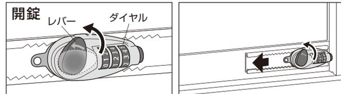
ダイヤルを暗証番号に合わせてレバーを矢印の方向に回して開錠し、ロック本体を引き抜いてください。
