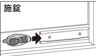
レールの溝にロック本体を差し込み、ダイヤルをランダムに回して施錠します。
