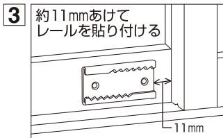
取付箇所の汚れをふきとり、サッシの端から11mmあけてレールを貼り付けます。（通常11mmあけることで、レールの調節長を最大限（25mm）に利用でき、換気ロックできます。）
