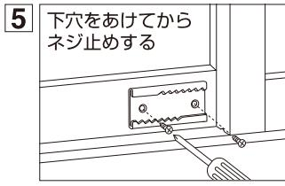
下穴が開いたら、同封のネジで固定してください。
