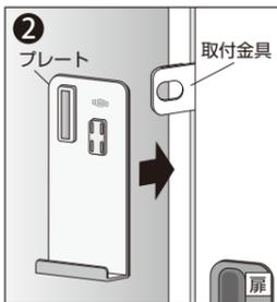
扉を閉めて、取付金具が当たらないか確認する。扉を閉めたとき、取付金具の先端部が左図のように飛び出した状態になります。
