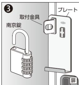
飛び出た取付金具の先端部にプレートを差し込みます。プレートには扉の接地面にゴムマグネットが付いているので、その位置で固定されます。
