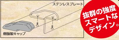
樹脂製キャップがステンレスプレートの両断面をネジ止めでしっかり固定しているので、変形が少なく、強引なこじ開けにも抜群の強度と耐久性で、ドアを破壊から守ります。
