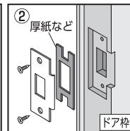
ドライバーでネジを外し、ストライクプレートを取り外し、適度な厚みの厚紙などをはさんでください。
