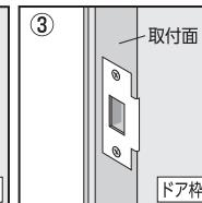
再度ストライクプレートを取付面と面一になるように取り付けてください。
