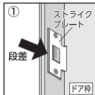
上図のようにストライクプレートが一段下がって凹んでいる（矢印の所の段差）場合は調整が必要です。
