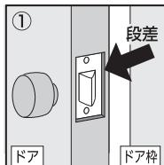
ドアの金具面が凹んでいるドアの場合（矢印の所の段差）は調整が必要です。
