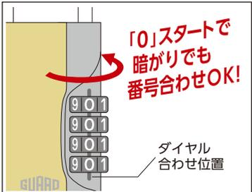
矢印方向に回すとダイヤルは、0・0・0・0で止まります。カチッと指に伝わる感触で数を確認でき、暗がりでも開錠できます。
