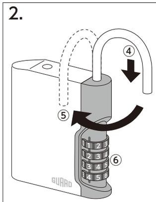
シャックルを押し下げるとバネの抵抗がありますが力を加えて最後まで押し下げてください。力を加えずに回すと故障の原因になります。
