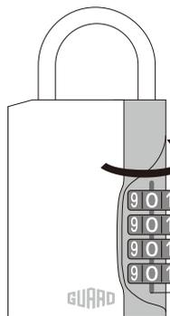
矢印方向に回すとダイヤルは、0・0・0・0で止まるようにできています。カチッと指に伝わる感触で数を確認できるので暗がりでも開錠しやすくなっています。
