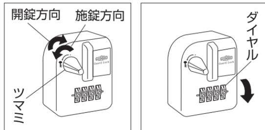
**施錠方法** ①開錠状態のロック本体を取付金具の出っ張りに差し込み、ツマミを左に回します。
