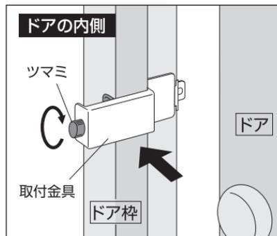
取付金具をドア枠にはめ、ツマミを回してドア枠にしっかり固定し、ドアを閉めるときに取付金具とドアが当たらないか確認します。
