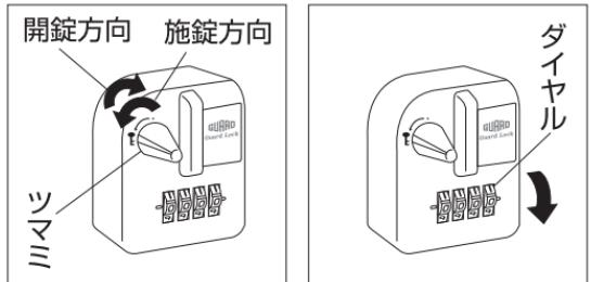
**施錠方法** ①開錠状態のロック本体を取付金具の出っ張りに差し込み、ツマミを左に回します。
