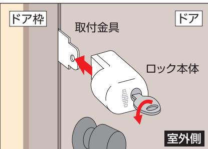
②ドアを閉めて、取付金具先端部にロック本体を差しこみ、キーを回して施錠します。
