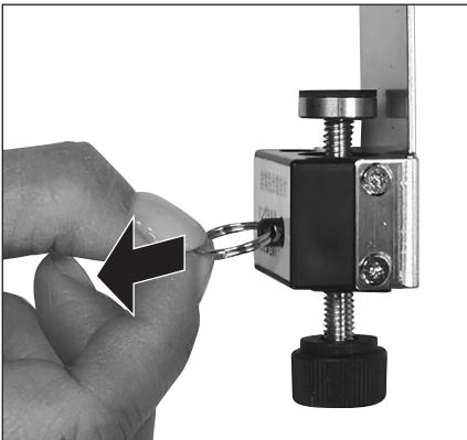
もしも外からロックされた場合は、リングを引きながらドアを開けてください。非常脱出機能部が根元で外れてドアが開きます。戻すときは、非常脱出機能部を差し込むと固定して通常通りご使用できます。
