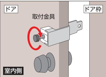
①取付金具をドアにはめ、ツマミを回してドアから落下しない程度に軽く固定する。（強く締め過ぎると非常脱出リングが引けなくなります。）
