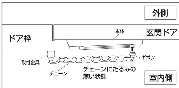
ドアを閉め、取付金具とチェーンを取り付けた状態で、レール穴にギボシがちょうど入る位置が最適です。チェーンのたれが多いと施錠後に外される場合があります。
