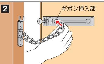
チェーン先端のギボシをギボシ挿入部に差し込む。
