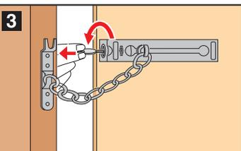
キーを左に回して施錠し、キーを抜く。そして、通常通りドアのロックをする。
