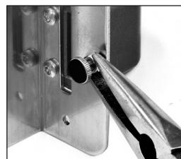
スペーサーの位置を決めた後に、緩み止め六角ナットをお手持ちのラジオペンチなどで締め付けてください。
