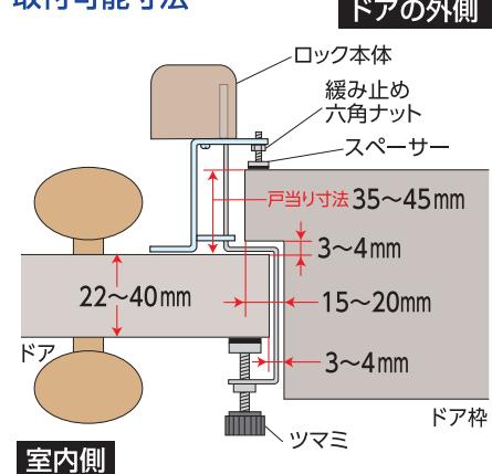
\*戸当り寸法45mmの場合は、スペーサーを取り外してご使用ください。(寸法によりガタツキが生じます。)
