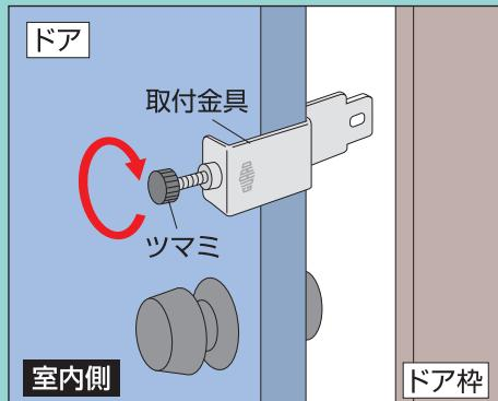
① 取付金具をドアにはめ、ツマミを回してドアにしっかりと固定し、ドアを閉める時に取付金具とドア枠が当らないか確認します。
