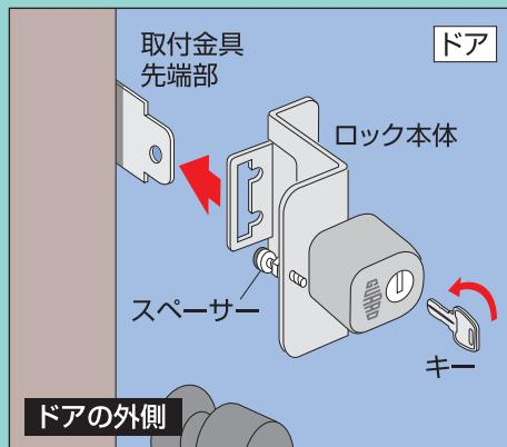
② ドアを閉めて、取付金具先端部にロック本体を差し込み、キーを回して施錠します。ドア枠との段差はスペーサーを回して調整してください。
