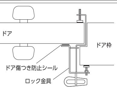
扉のすり傷防止のため「ドア傷つき防止シール」が付属しています。ロック金具とドアの接地面にシールを貼り付けてください。
