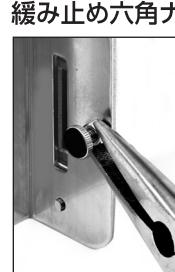
スペーサーの位置を決めた後に、緩み止め六角ナットをお手持ちのラジオペンチなどで締め付けてください。
